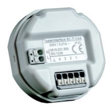
Das SC-TI-CAS ist ein Eingabemodul für bis zu 4 potentialfreie Taster. Das Gerät wird automatisch von der Casambi-App erkannt und kann in das vorhandene Netzwerk aufgenommen werden. Die Funktionen, welche von den Tastern ausgelöst werden sind mit der Casambi-App zu konfigurieren.
